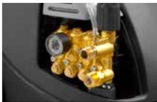
1 Motopompa professionale con motore 4 poli (1400 rpm) e pompa lineare autoadescente: la bassa velocità di rotazione allunga sensibilmente la vita dei componenti interni alla motopompa, garantendone una maggiore efficienza e silenziosità
