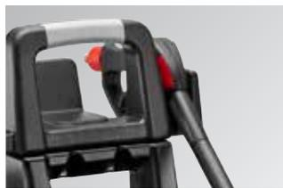
Total Stop ritardato ed in bassa tensione: il dispositivo ritarda di 15 secondi lo spegnimento dell'idropulitrice dall'ultimo rilascio della leva della pistola, per sicurezza, risparmio energetico e prevenzione di guasti o surriscaldamenti della motopompa.
