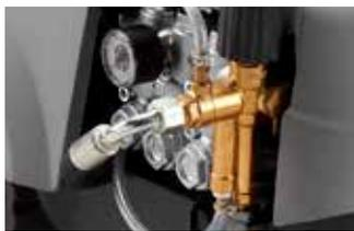
Nuova pompa CL 6.0 autoadescante a tre pistoni in ceramica integrale, cuscinetti a rulli conici, doppio visore olio e testata in ottone
