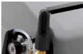
Nuova valvola di regolazione pressione flangiata L3.1, passaggi interni ridimensionati per garantirne il corretto funzionamento anche in condizioni di alte portate d'esercizio
